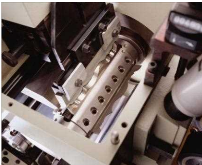
Profiljointer für Arbeitsbreite 230 mm, automatisch: Bei geschlossener Sicherheitshaube fernbedienbar, incl. automatischer Steinzustellung. In Kombination mit Geradejointer kann der Profiljointer in Position bleiben. Arbeitsbreite bei Gegenlager 230 mm, ohne Gegenlager 120 mm.
