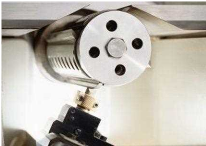
Geradejointer automatisch Mitlaufend bei radialer Verstellung der Spindel. Bei geschlossener Sicherheitshaube fernbedienbar. Für Werkzeugflugkreis 125 - 180 mm. Jointbreite bei konventionellen Hydro-Werkzeugen ohne Gegenlager max. 120 mm. Jointbreite bei konventionellen Hydro-Werkzeugen mit Gegenlager max. 310 mm.
