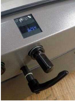
Elektronische Digitalanzeige für Radialverstellung Ihr Vorteil - Exakte und schnelle Positionierung der Spindel
