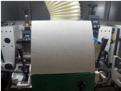
Andruck nach oberer Spindel, pneumatisch
