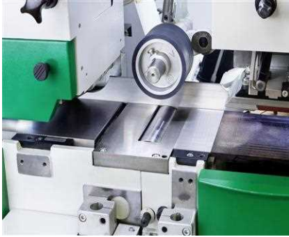
Drei angetriebene Rollen im Maschinentisch, gehärtet
