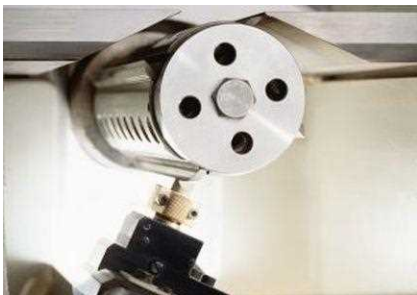
Radiale CNC - gesteuerte Verstellung und Positionierung der Spindel
