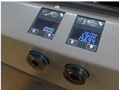
Axiale CNC - gesteuerte Verstellung und Positionierung der Spindel
