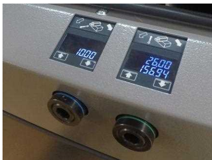
Radiale CNC - gesteuerte Verstellung und Positionierung der Spindel für Hochleistungspaket.
