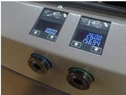
Radiale CNC - gesteuerte Verstellung und Positionierung der Spindel
