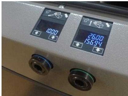
Axiale CNC - gesteuerte Verstellung und Positionierung der Spindel
